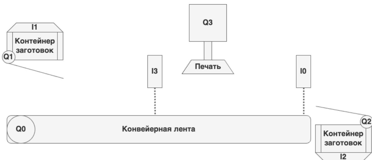
**Рисунок 1.1 — Схематическое изображение установки**
