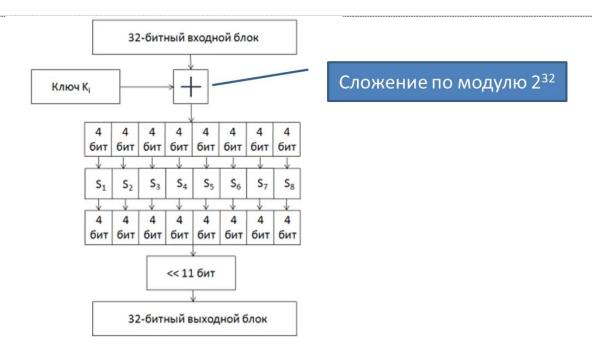
S-блоки в стандарте не определены, но должны быть одни и те же S-блоки для шифрования и расшифровки. Например, можно использовать следующую таблицу:
