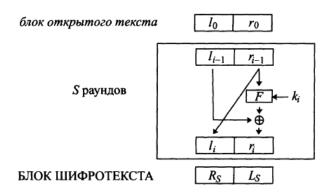
Всё исходное сообщение разбивается на блоки по 64 бита. Каждые 64 бита обрабатываются отдельно согласно схеме Фейстеля в течение 32 раундов.
